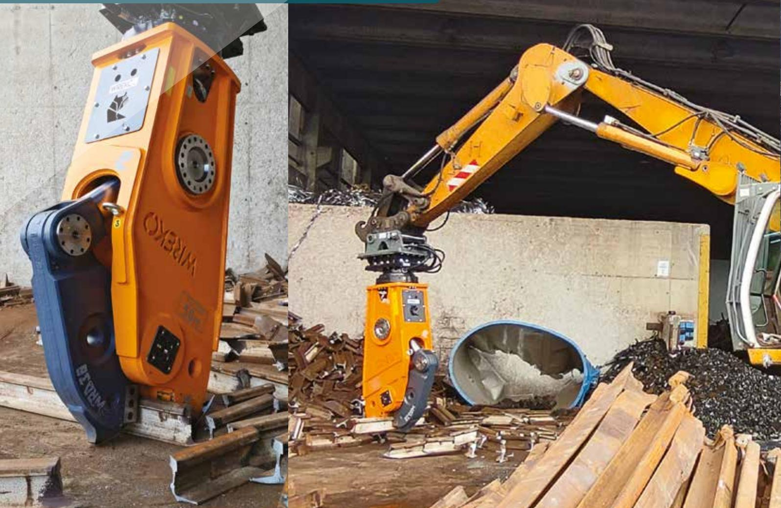
La **Spacca Rotaie WRD** è un accessorio innovativo progettato per la **riduzione volumetrica** delle attuali **rotaie** Vignol, dalle tipologie "S7" a "UIC60" e oltre, con una qualità dell'acciaio fino a R350HT (con tempra in testa).
