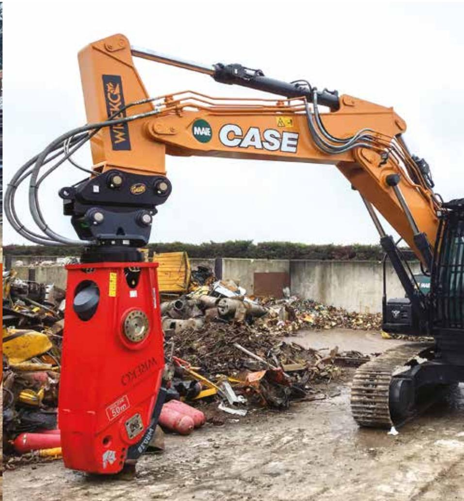
La WRD è dotata di una rotazione idraulica compatta a 360°, che è efficiente e altamente affidabile, garantendo una maneggevolezza senza pari durante le operazioni di lavoro.
